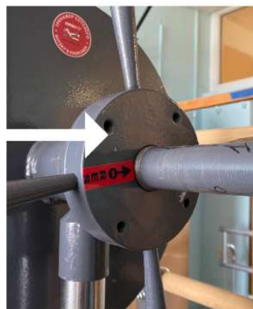
Рисунок – Шкала для дозирования нагрузки на фрикционном тренажере «Бизон-У»
