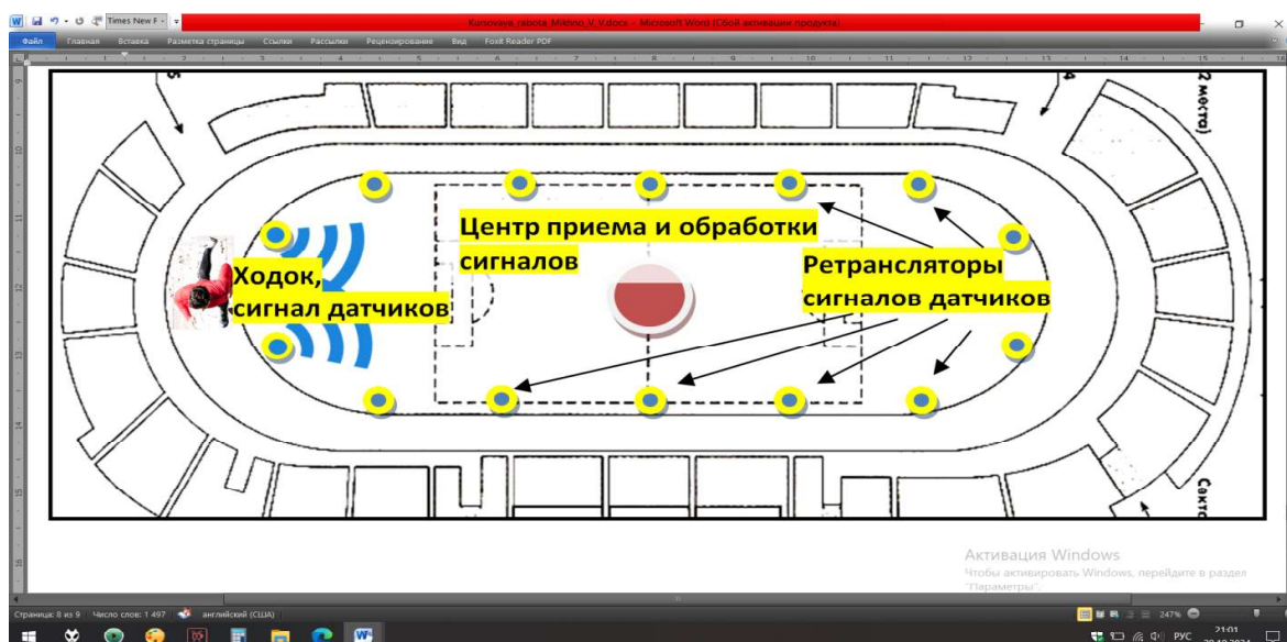
Рисунок 2 – Система ретрансляторов с центром приема и обработки информации
